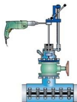
2. Borrutrustning monteras och röret anborras
