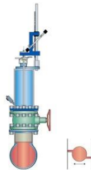
5. Blockeringskroppen aktiveras och röret är nu blockerat
